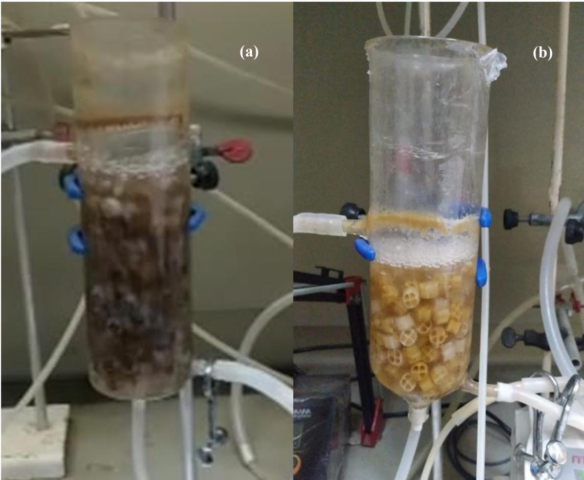
Figura 5-13 – Coloração do biofilme na FASE 2, dia 120, (a), e na FASE 3 (b), dia 220.
