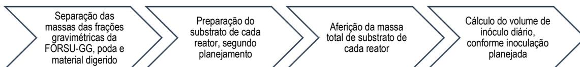
**Figura 8.4.** Fluxograma de montagem dos reatores de bancada.
