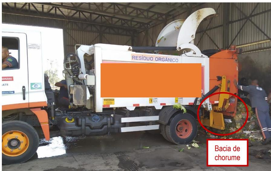
**Figura 5.5.** Ponto de coleta da fração líquida da FORSU-GG.
