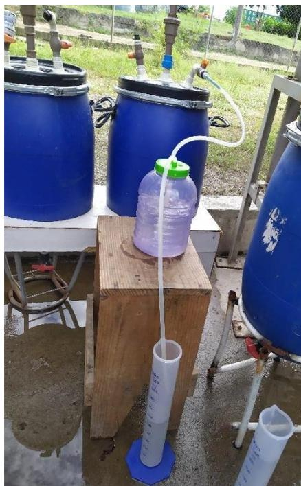
**Figura 8.7.** Sistema de quantificação de biogás dos reatores de bancada.
