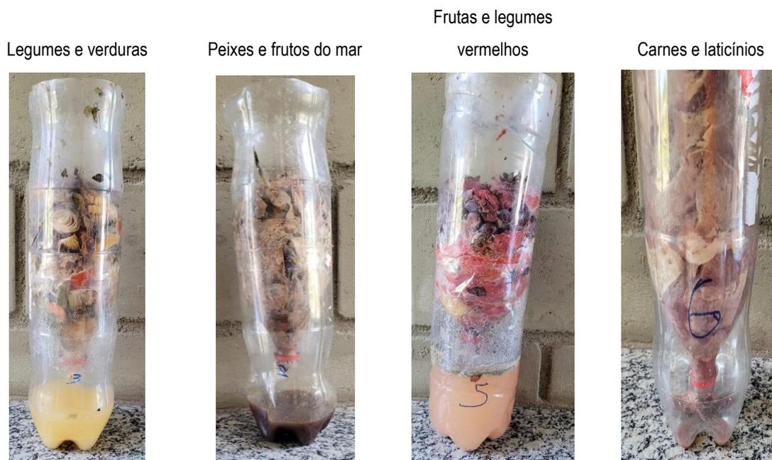
**Figura 5.13.** Variação da fração líquida proveniente da fração sólida da FORSU-GG.
