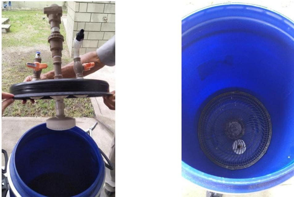
**Figura 8.3.** Detalhe da tampa e da base dos reatores de bancada.
