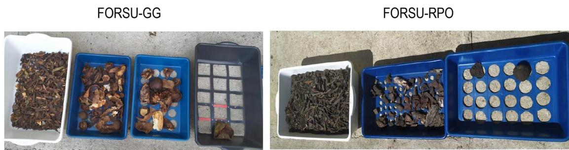
**Figura 5.10.** Ilustração da caracterização granulométrica da FORSU-GG e FORSU-RPO.
