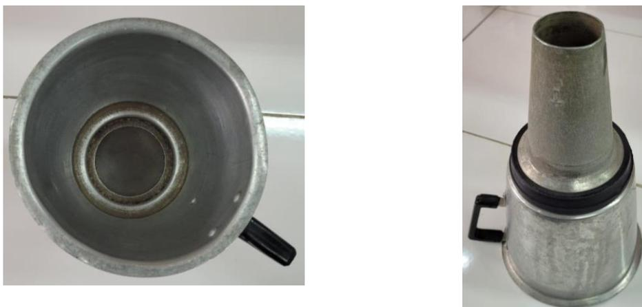
**Figura 6.3.** Peneira utilizada para a filtração de sólidos grosseiros das amostras de lixiviado.
