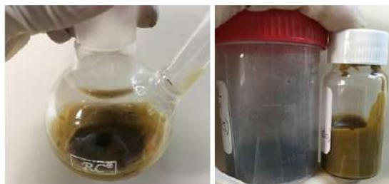
Figura 5.86: Fração condensável (esquerda) e frações de resíduo e condensável (direita) da pirólise de uma alíquota do RSU (enriquecido em PE) cedido pela Estre Ambiental.
