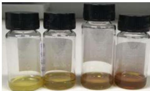
Figura 5.65: Frações de condensáveis obtidos nos 04 ciclos da pirólise catalítica empregando-se ZSM5, sendo o ciclo 01 mais à esquerda e ciclo 04 mais à direita.
