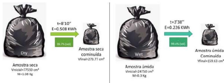
Figura 5.4: Representação esquemática da diminuição de volume relacionada à cominuição dos resíduos.
