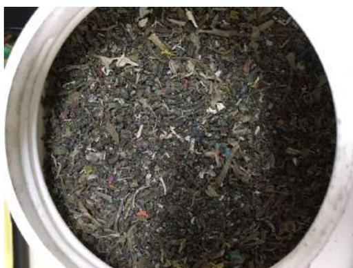
Figura 4.6: Material cominuído oriundo de RSU enriquecido com PE após triagem na unidade Estre Ambiental.
