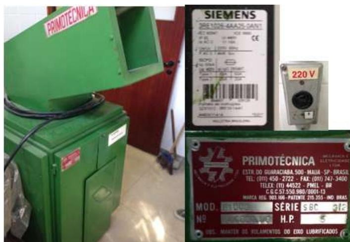
Figura 4.5: Moinho de facas (e suas especificações) utilizado na cominuição das amostras residuárias (IMA/UFRJ).
