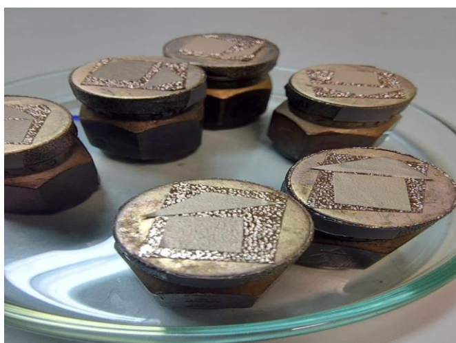
Figura 3.5 - Amostras de membranas de matriz mista compostas após metalização com alvo de ouro
