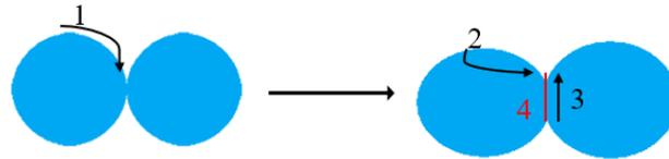
**Figura 5-** Mecanismos de sinterização. (1) difusão de superfície, (2) difusão de volume, (3) difusão de contorno de grão e (4) região de contorno de grão.
