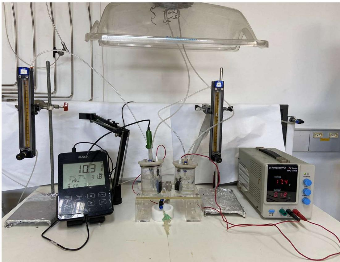
**Figura 33 – Sistema usado nos experimentos de geração de H<sub>2</sub>O<sub>2</sub> com a célula tipo H.**
