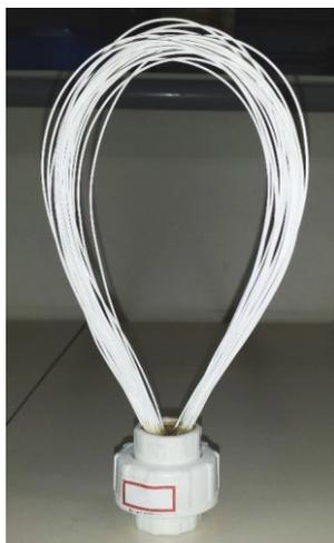
Figura 19: Fotografia do módulo de microfiltração utilizado nos experimentos.
