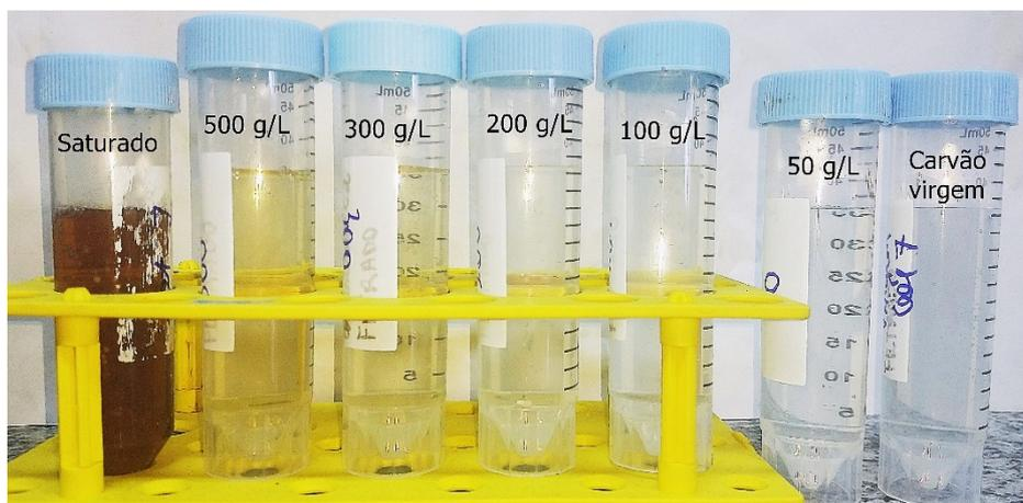
Figura 65: Fotografia das amostras tratadas pelo CAP regenerado em soluções de  $H_3PO_4$ .
