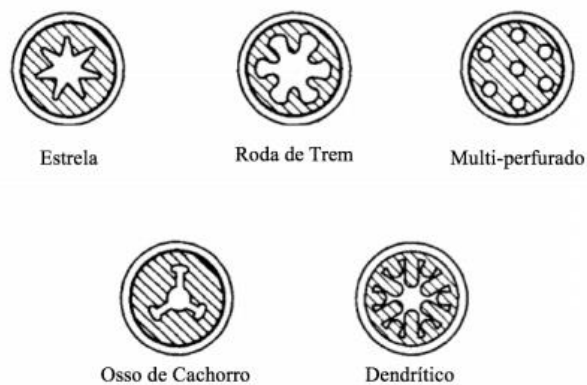
Figura 2-4. Modelos característicos de geometria do grão do propelente para queima radial (FONTE: SUTTON, 2001).
