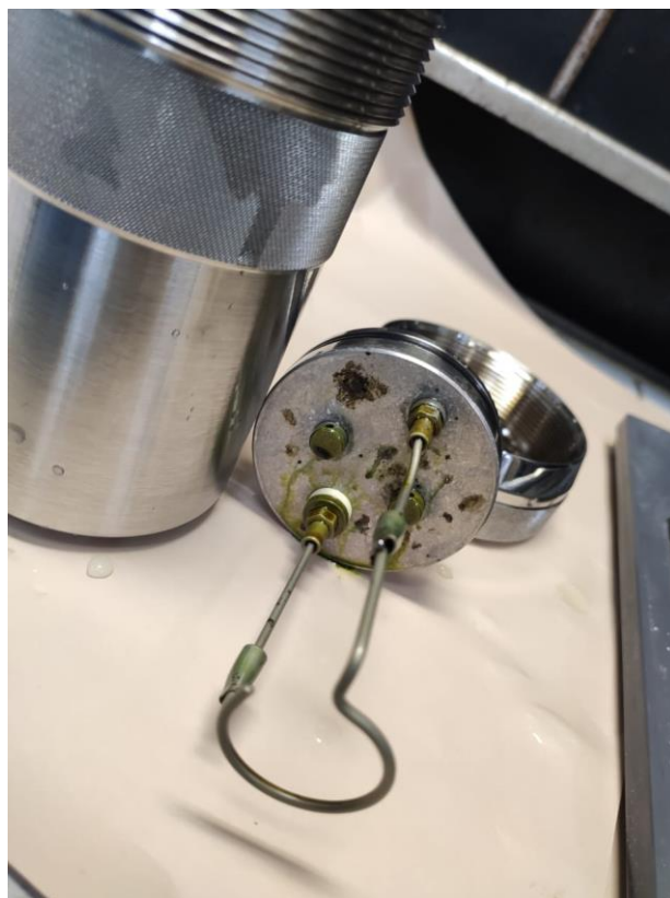
Figura 5-78. Ilustração do estado típico da tampa da célula de medida do calorímetro após o término da análise.
