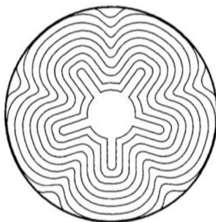
Figura 2-3. Diagrama de contornos de sucessivas superfícies de frente de queima (Fonte: SUTTON, 2001).
