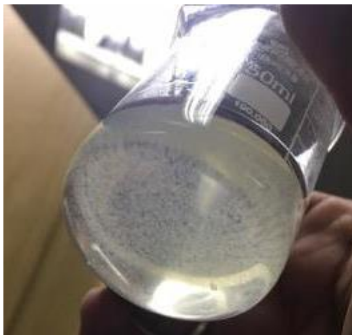
Figura 5-2. Polímero sintetizado e disperso em acetona.
