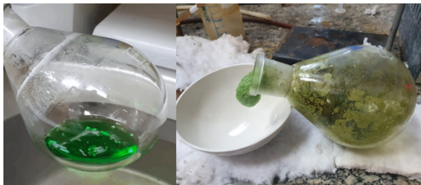
Figura 3.2: Preparação dos catalisadores embutidos com Ni.
