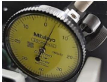
**Figura 5.4.** Imagem do relógio apalpador utilizado nos experimentos (CURCINO, 2020).
