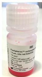
**Figura 5.5.** Partículas traçadoras de poliestireno comercializadas pela Thermo Fisher.
