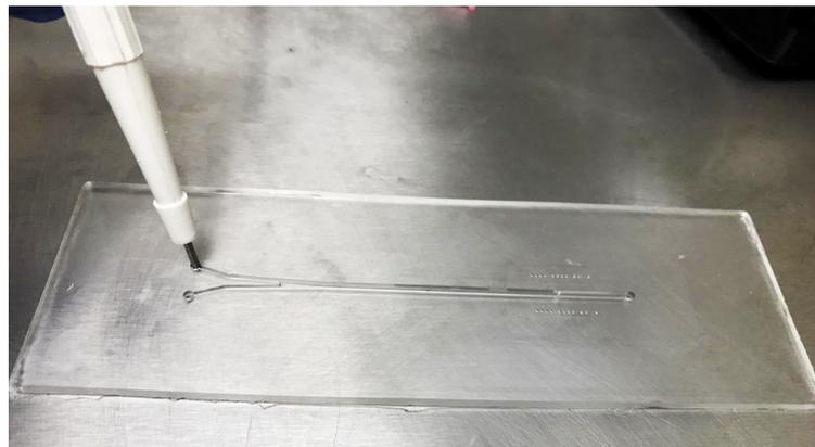
**Figura 4.10.** Uso do *punch* para fazer o furo que será a conexão com a mangueira (meio externo).
