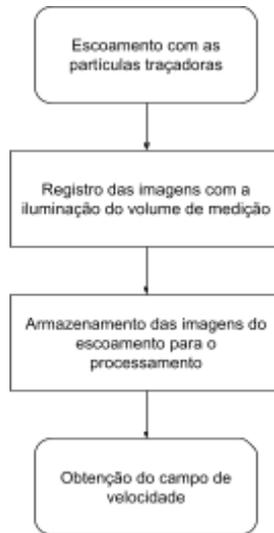
**Figura 3.3.** Fluxograma para medição do campo de velocidade com a técnica PIV. Adaptado de CURCINO, (2020).
