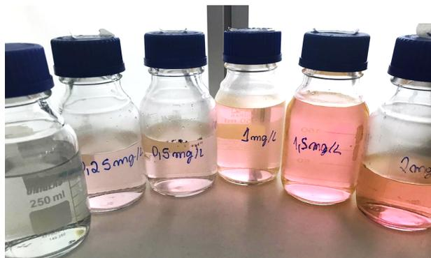
**Figura 5.23.** Soluções de rodamina 6G em água deionizada, nas concentrações de 2 mg/L, 1,5 mg/L, 1 mg/L, 0,5 mg/L, 0,25 mg/L e 0 mg/L.
