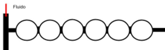
**Figura 2.2.** Desenho esquemático de um micromisturador que funciona com o conceito de divisão e recombinação (Adaptado de ANSARI *et al.*, 2010).
