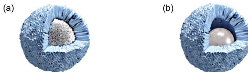
Figura 2.15: Ilustração de partículas (a) *core-shell* e (b) *yolk-shell* (adaptado de JIANG *et al.*, 2020).
