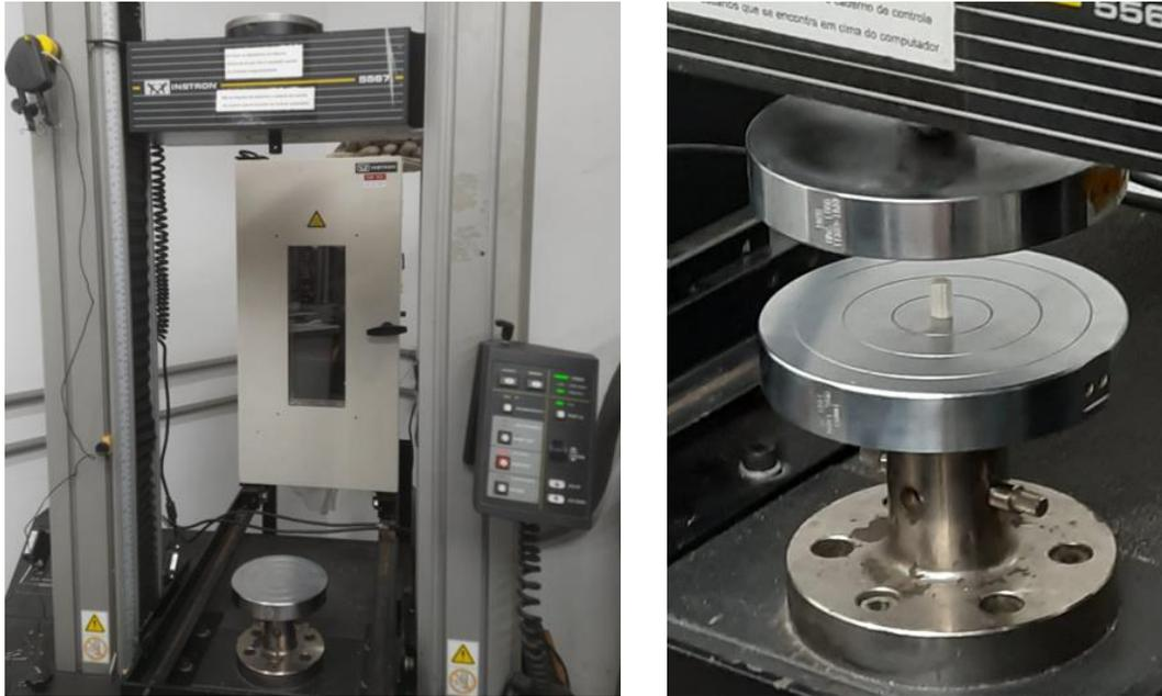
**Figura 3.5-** Equipamento Instron 5567 presente no Laboratório de Processamento e Caracterização de Materiais. À direita, a peça de monolito posicionada entre as duas placas para realização dos testes de compressão.
