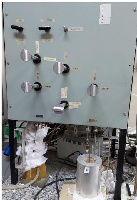
**Figura 3.6-** Unidade de teste catalítico presente no NUCAT. À esquerda, o saturador de água. À direita, reator dentro do forno elétrico com termopar acoplado.
