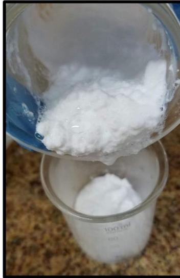
Figura 5.16. Aglomeração e perda de estabilidade da reação de encapsulamento *in situ* com copolímero de MMA e AA, nomeado P(MMA-AA)10%\_R.
