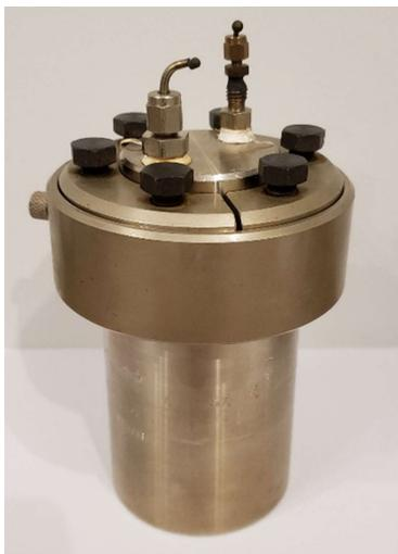
Figura 23 - Reator empregado no método solvotérmico.
