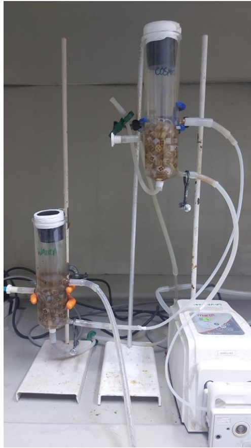
Figura 4.2: Reatores de leito móvel com biofilme durante operação
