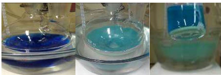
Figura 17: Variação de coloração e turbidez durante a precipitação de NiMoW
