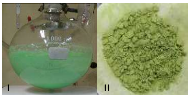
Figura 18: Suspensão NiMoW ao final da reação (I) e precipitado NiMoW seco (II)
