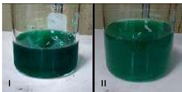
Figura 15: Solução B na síntese NiMoW – apenas níquel (I), níquel + molibdênio (II)
