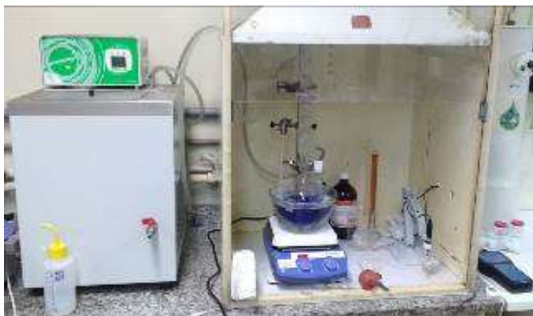
Figura 16: Sistema reacional utilizado para a precipitação dos precursores
