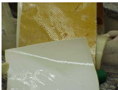
FIGURA 4.15 – Fotografias Comparativas da superfície da membrana antes e depois da limpeza mecânica.
