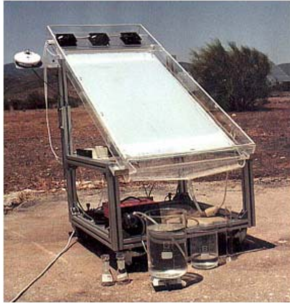
Figura 2.10. Fotografia do TFFBR instalado em Almeria na Espanha (Foto: D. Bockelmann). Fonte: BAHNEMANN, 2004.
