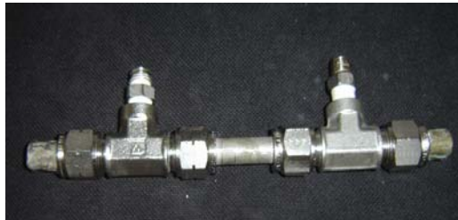
Figura 3.4: Carcaça de aço inoxidável utilizada na construção dos módulos de permeação gasosa. A entrada e saída da corrente de alimentação ocorrem pela lateral do módulo. A corrente de permeado é retirada por uma das extremidades.
