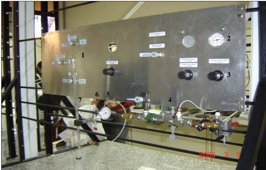
Figura 3.8: Sistema de permeação gasosa para medição da permeabilidade dos gases puros. (1) Gases de alimentação (CO 2 e N 2 ), (2) e (5) Manômetros, (3) Válvula de ajuste da pressão de alimentação, (4) Módulo de fibras ocas, (6) Válvula micrométrica para ajuste da pressão do permeado, (7) Fluxímetro de bolhas.
