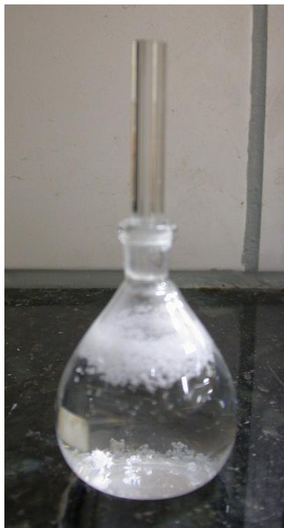
**Figura 5.3:** Fração de partículas na superfície durante a picnometria com água.
