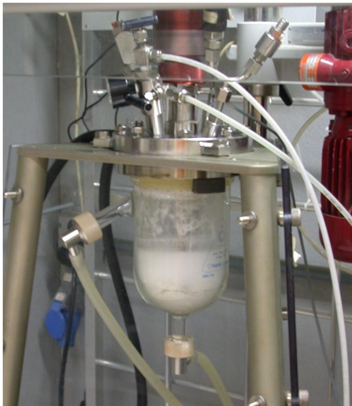
**Figura 3.7:** Fração de PVAc retida no reator após a equalização da pressão do sistema.
