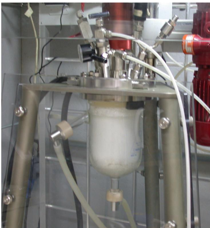
**Figura 3.5:** Unidade experimental pressurizada de reação.
