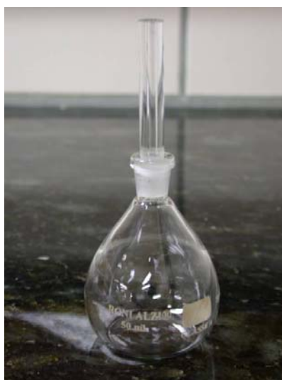
Figura 4.4: Picnômetro usado nas análises de picnometria.
