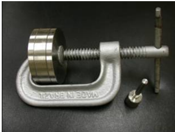
Figura 4.2: Molde usado para preparação dos corpos de prova (montado).
