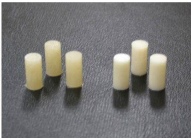
Figura 4.3: Alguns corpos de prova confeccionados para o ensaio de resistência à compressão.
