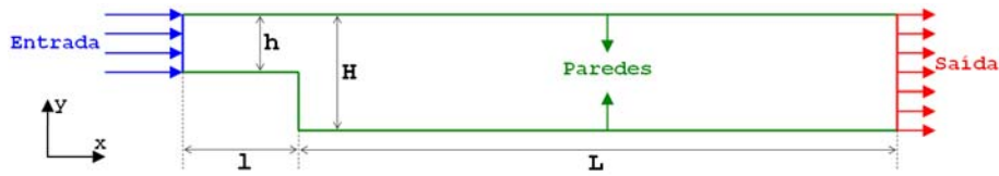
Figura 4.13: Geometria 2D do BFS com dimensões paramétricas e indicação das condições de contorno.
