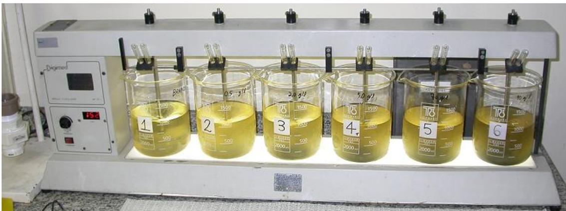
Figura 19: Foto ilustrativa do equipamento utilizado para o teste de jarro com carvão ativado granulado, no qual variou-se a concentração de CAG de 0,5 a 10 g.L<sup>-1</sup>.
