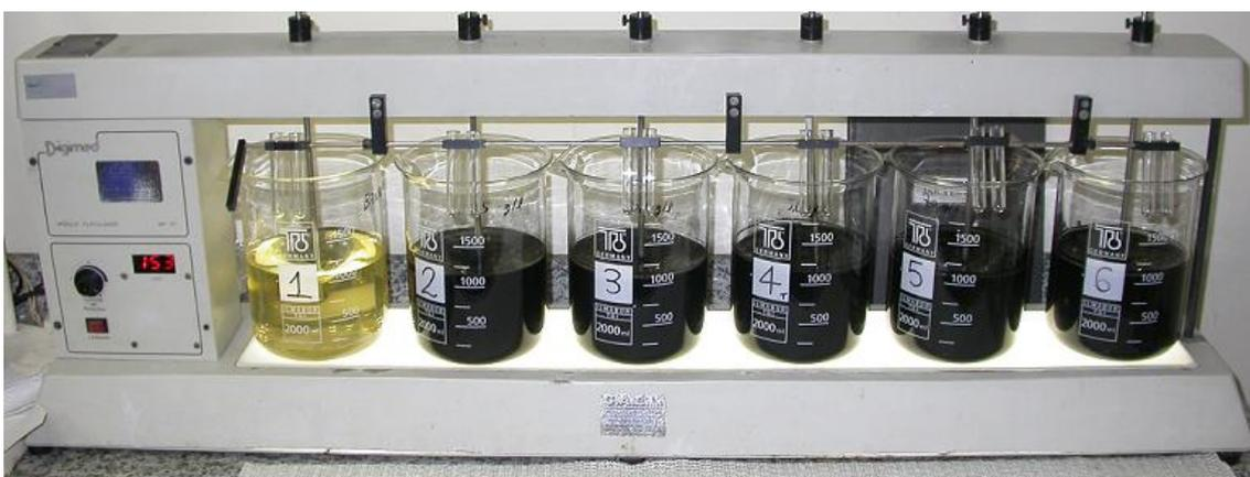
Figura 20: Foto ilustrativa do equipamento utilizado para o teste de jarro com carvão ativado em pó, no qual variou-se a concentração de CAP de 0,5 a 10 g.L<sup>-1</sup>.
