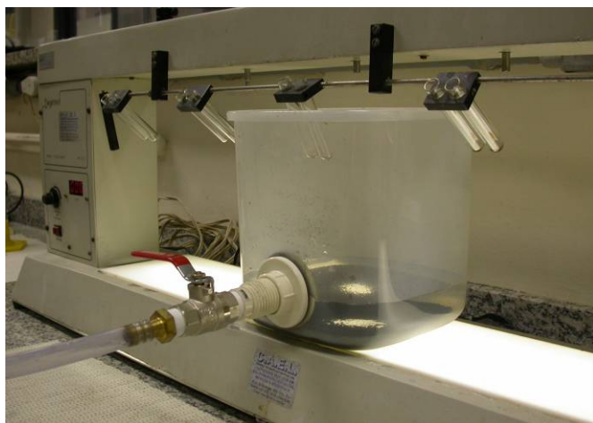
Figura IV.7 – Reator de 4,0L de coagulação/Floculação e sedimentação
