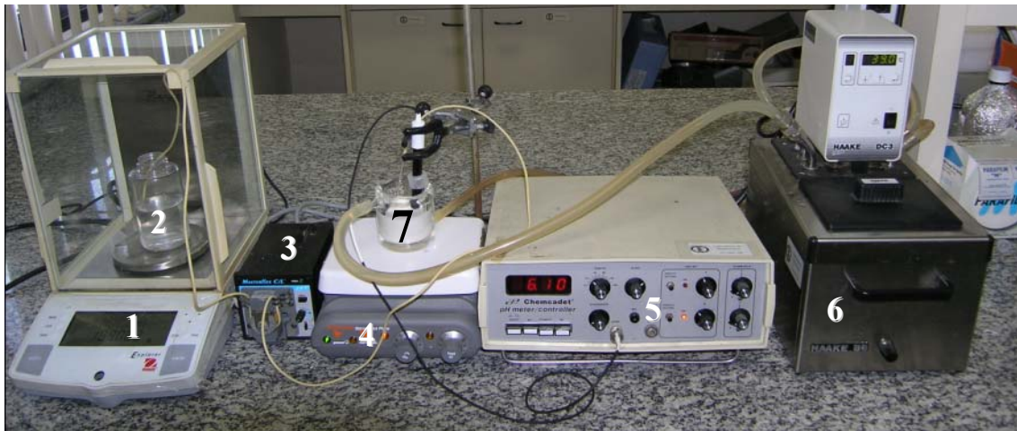
Figura 3.7 – Foto do sistema utilizado nos estudos com células livres, onde: 1 – balança; 2 – solução de NaOH; 3 – bomba; 4 – placa de agitação; 5 – sistema de controle de pH; 6 – banho termostático; 7 – biorreator encamisado.
