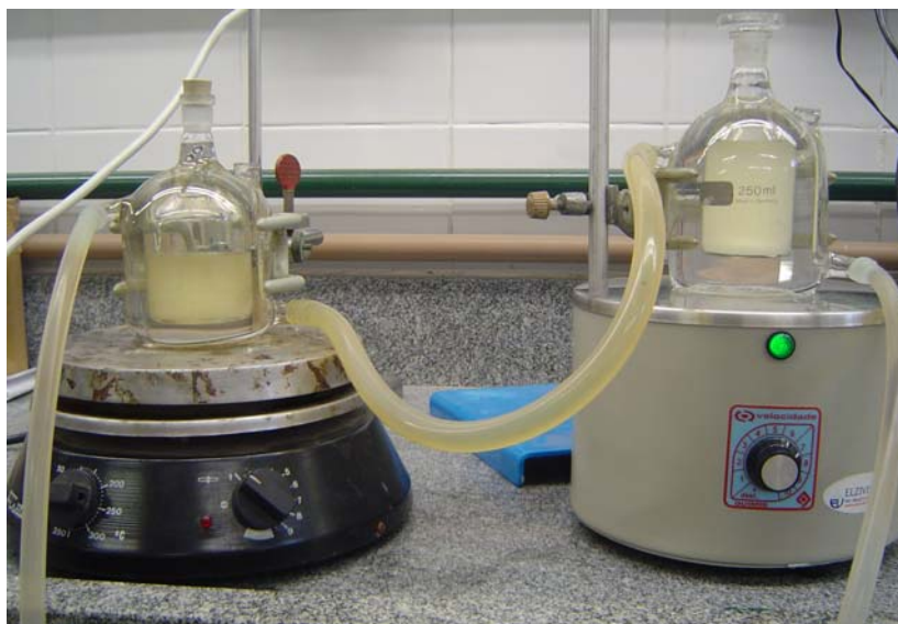
Figura 9: Sistema biodiesel de mamona + glicerina + metanol sendo agitado. Células acopladas ao mesmo banho termostático.
