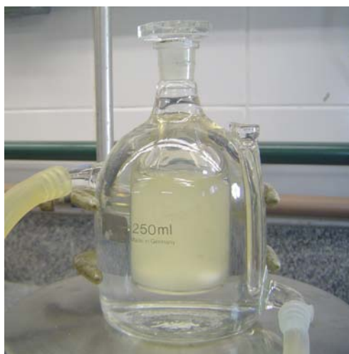
Figura 26: Mistura de biodiesel + glicerina + metanol sendo agitada.
