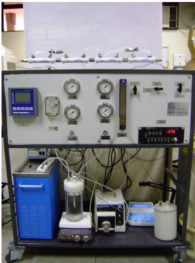
Figura 3.6: Detalhe do sistema de Contactores com Membranas operando com quatro contactores conectados em série (segundo sistema)
