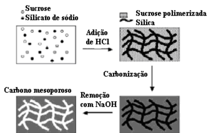
Figura 2.13: Diagrama esquemático para a síntese dos carbonos mesoporosos através da polimerização in-situ de silicato de sódio e sucrose (HAN et al. , 2003a).
