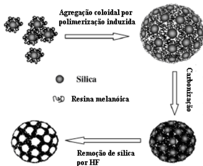
Figura 2.30: Esquema do procedimento de síntese para o carbono MCS sintetizado por W. LI et al. (2007a).
