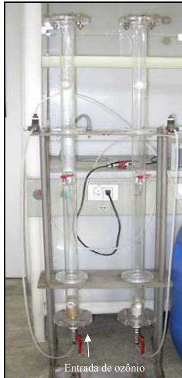
Figura IV.5. Reator B utilizado para ensaios de ozonização
