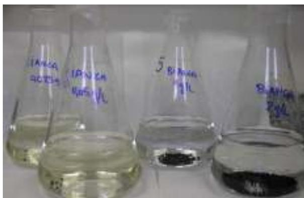
Figura IV.9. Frascos com diferentes massas de CAG após reação.
