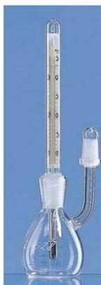
Figura 4.4: Picnômetro utilizado na medida da densidade do carvão ativado
