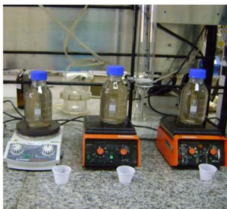
Figura 4.6: Frascos utilizados nos ensaios de adsorção em carvão ativado em banho finito.
