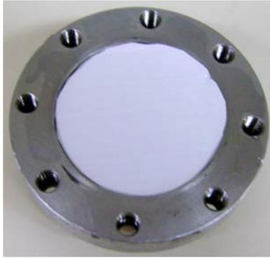
Figura 5.8: Membrana de OI e célula de permeação
