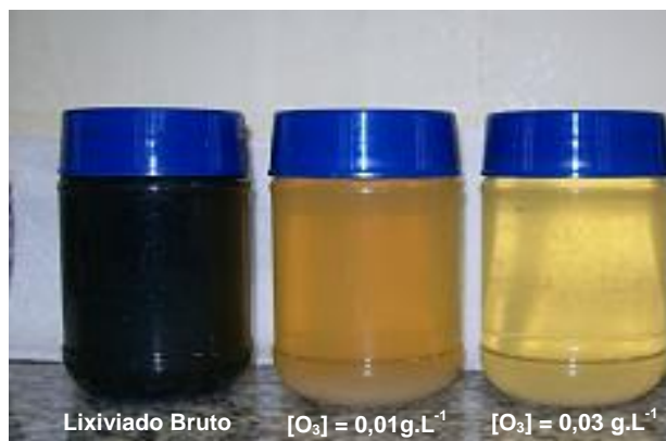
Figura 4.5 – Foto da redução de cor do lixiviado pelo processo de ozonização com duas doses de ozônio aplicadas nos ensaios.
