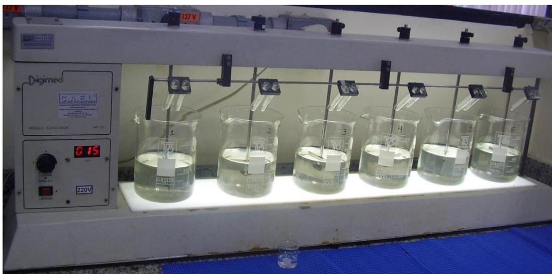
**Figura 4.5 – Fotografia da unidade experimental (teste de jarro)**
