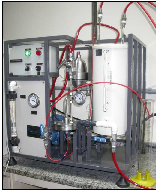
Figura 4.8 Sistema de osmose inversa- escala de bancada.
