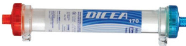
Figura 3.1: Módulo de membrana utilizado nos testes de extração em contactor (BAXTER HEALTHCARE).
