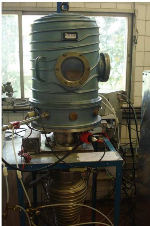
Figura 3.7. Sistema de deposição por magnetron sputtering.
