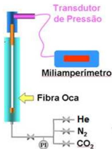
Figura 3.9. Representação do sistema de permeação a gases puros para membranas de carbono. (Adaptado de BARBOSA-COUTINHO, 2004).
