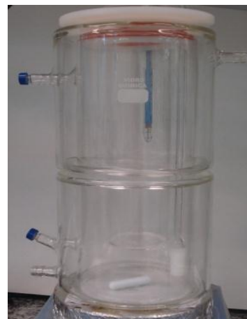
Figura 3.3 – Esquema e foto do reator fotocatalítico.
