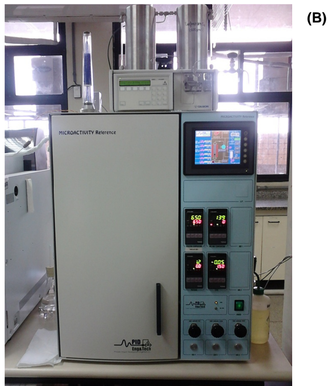
Figura 3.3 – Unidade de Avaliação Catalítica: (A) representação esquemática; (B) foto da unidade. (Fonte Adaptada: Manual Microactivity Reference – PID Eng&Tech, 2007)
