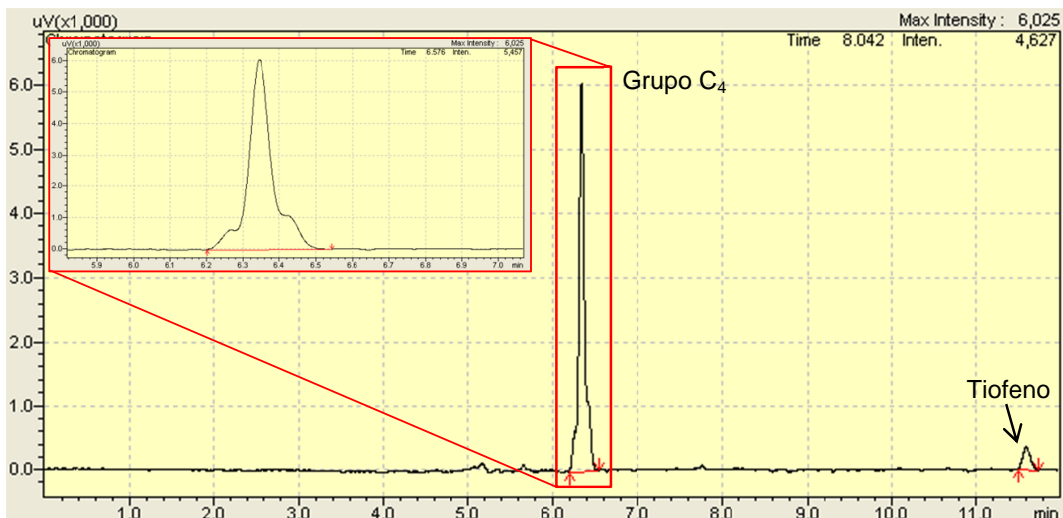
Figura 3.5 – Cromatograma típico do gás obtido durante a reação (em destaque a região dos produtos de reação).
