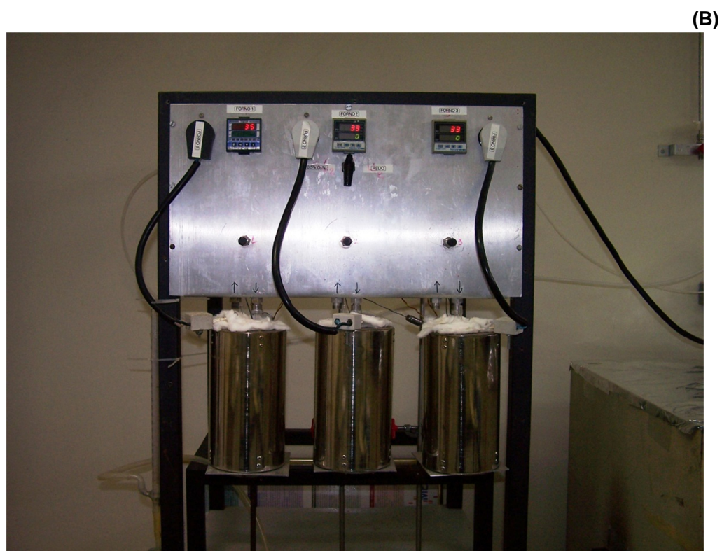
Figura 3.1 – Unidade de Decomposição: (A) representação esquemática; (B) foto da unidade.
