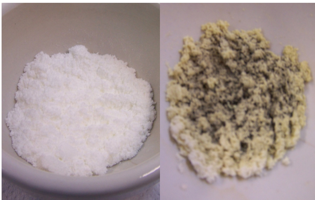
Figura 4.4 – Precursores obtidos a partir da reação em ar com temperaturas iguais a 150 °C (esquerda) e 200 °C (direita).
