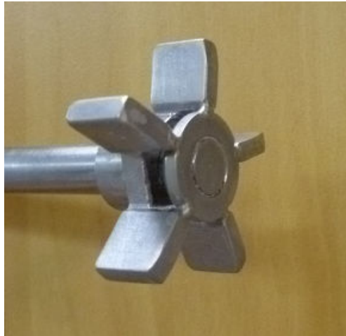
Figura 3.2 – Impelidor de 6 pás utilizado na agitação do meio reacional
