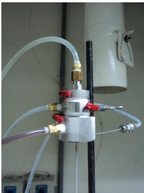
**Figura IV.33** Fotografia da extrusora quádrupla durante o processo de fiação.
