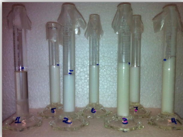
Figura 3.8. Provetas para medição da estabilidade e quantidade de óleo liberado após 15 dias.
