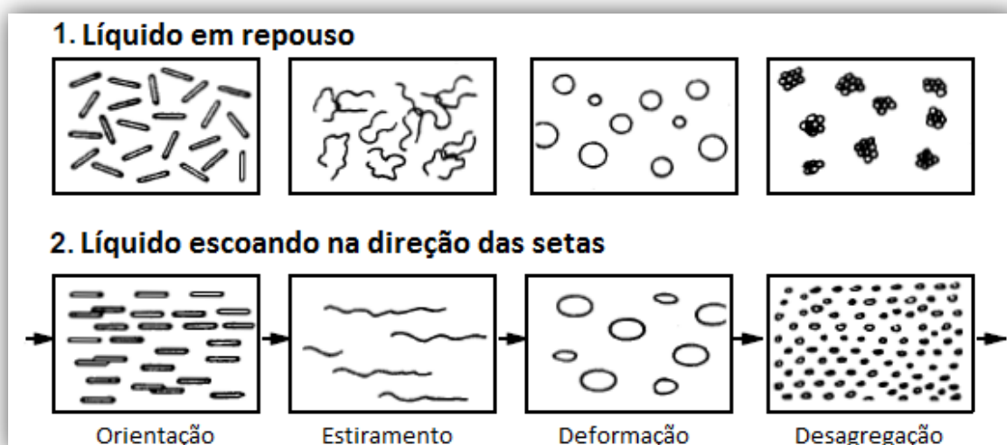
Figura 2.10. Representação esquemática de um líquido em repouso (1) e após a aplicação de uma taxa de cisalhamento (2).
