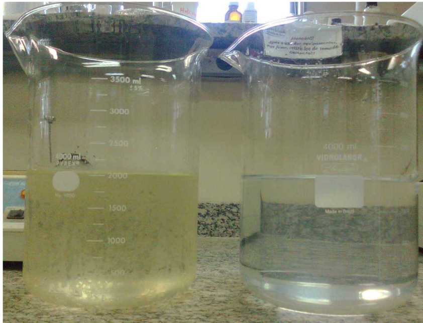
Figura 5.4: Comparação visual entre os efluentes com e sem tratamento. (a) Efluente secundário da REGAP e (b) Efluente após pré-tratamento com POA na condição 1C:4H 2 O 2 / 95W.
