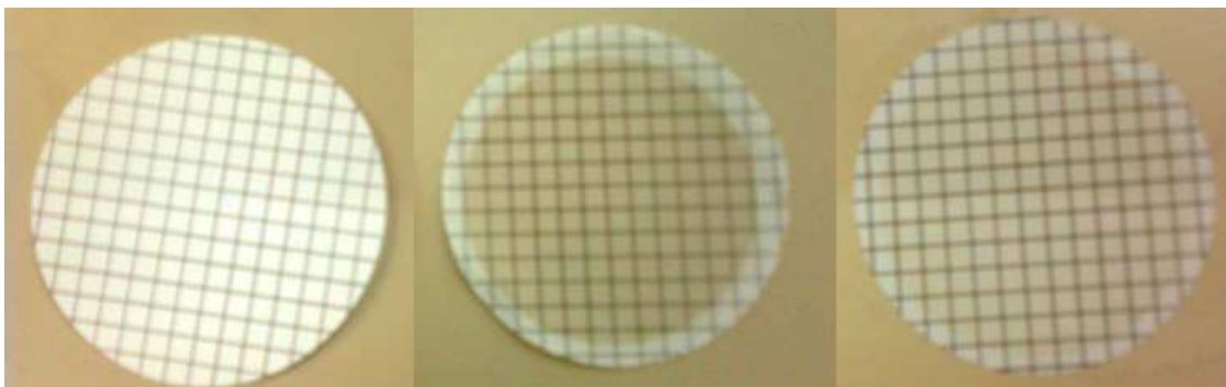
Figura 5.22: Comparação visual entre as membranas de Nitrato de Celulose após o ensaio de SDI. (a) membrana nova, (b) efluente secundário, (c) efluente após POA
