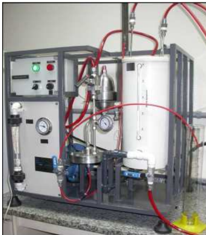
Figura 4.5: Sistema de Osmose Inversa.
