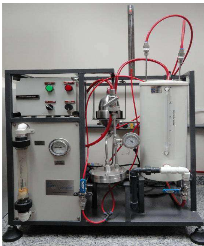
Figura 4.11 – Sistema de Osmose Inversa
