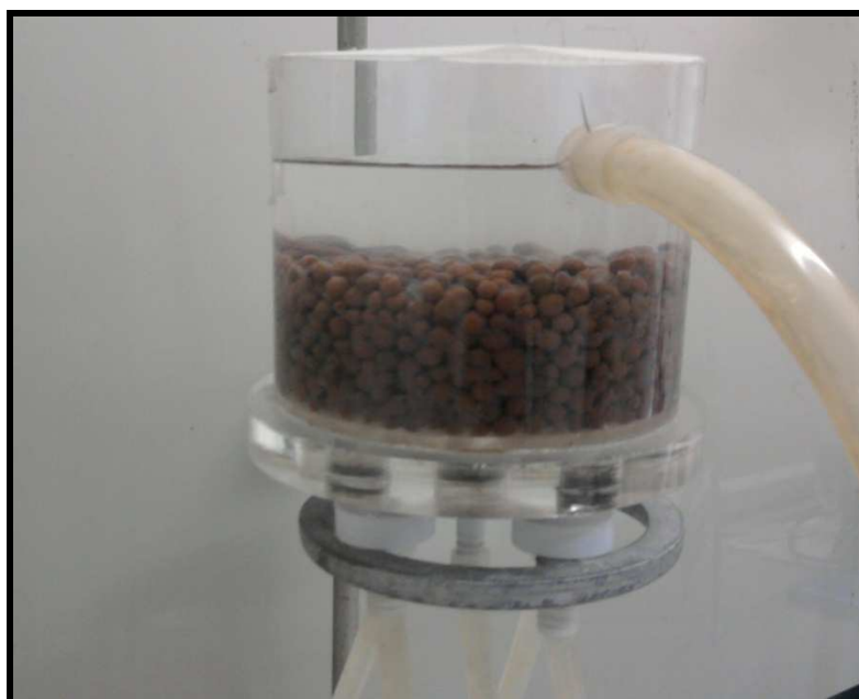
Figura 4.5: Reator utilizado na 2ª etapa dos ensaios com Biofiltro.
