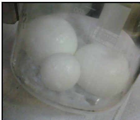
Figura 4.2. Grandes aglomerados gerados na reação em foi empregada uma vazão de 0,127 l/h.
