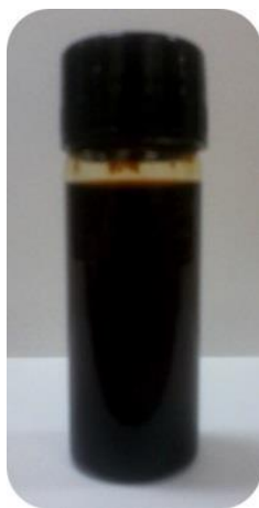
Figura 4.12 – Bio-óleo produzido na melhor condição de pirólise do bagaço de cana-de-açúcar (tamanho de partícula de 60 mesh Tyler, vazão de N 2 de 75 mL min -1 e temperatura de pirólise de 500 °C).
