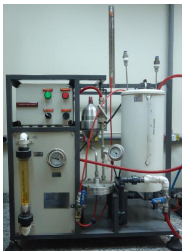
Figura 4.9 – Fotografia do sistema de bancada de osmose inversa.
