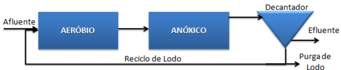
Figura 3.4 – Representação esquemática do sistema de pós-desnitrificação
