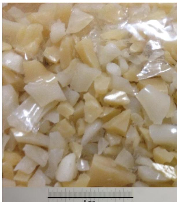
**Figura 15** - Aparas de PMMA reticulado moídas.
