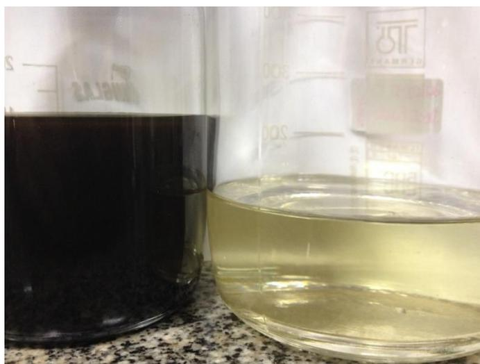
**Figura 40** - Coloração do líquido obtido nas reações na unidade semi-piloto antes e depois da etapa de purificação.
