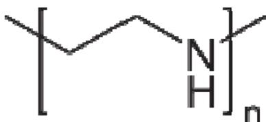
**Figura 4.14:** Estrutura da polietilenoimina.
