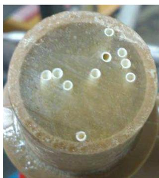
**Figura 3.10:** Detalhe da seção transversal cortada, mostrando as fibras ocas fixadas pela resina epóxi do tipo Araldite®.
