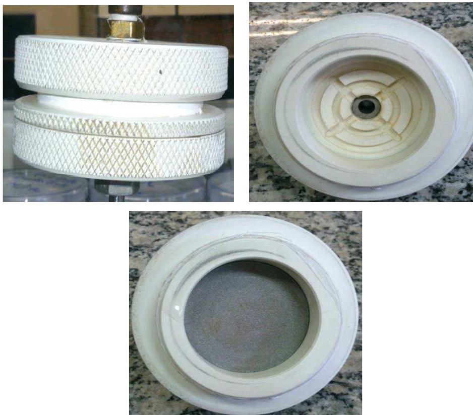
**Figura 3.6:** Célula de permeação utilizada na medição da permeabilidade hidráulica das membranas planas.
