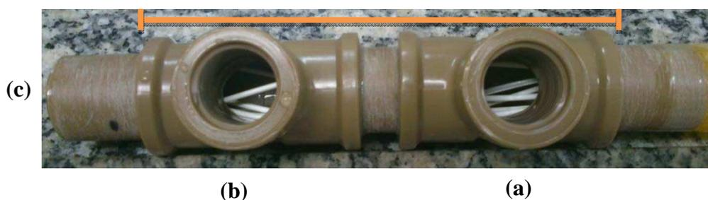
**Figura 3.9:** Detalhes do módulo de permeação confeccionados para medição das propriedades de transporte das fibras ocas: (a) Entrada da alimentação (b) Reciclo da alimentação (c) Saída de permeado.
