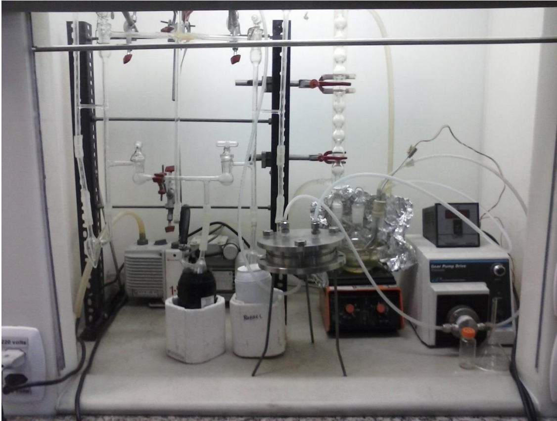
Figura 15. Unidade de Pervaporação com membrana plana para testes com mistura sintética.
