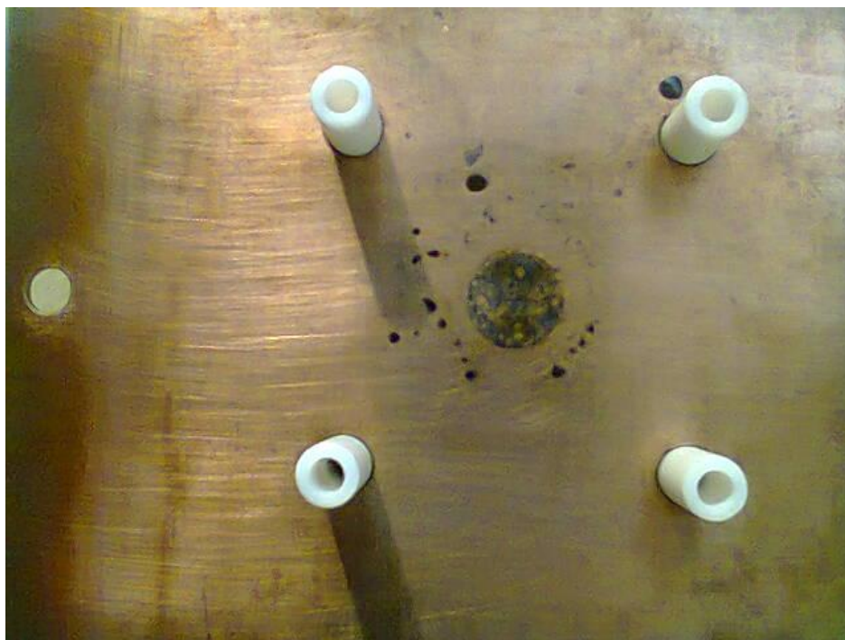
Figura 49: Foto de um eletrodo desgastado após uma das análises de CEC. Nele podemos encontrar manchas pretas de óxido de cobre (II).
