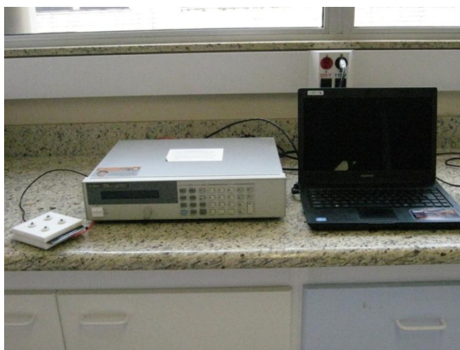
Figura 22: O sistema de eletrocoalescência, contendo a célula, a fonte de tensão e o computador de controle.
