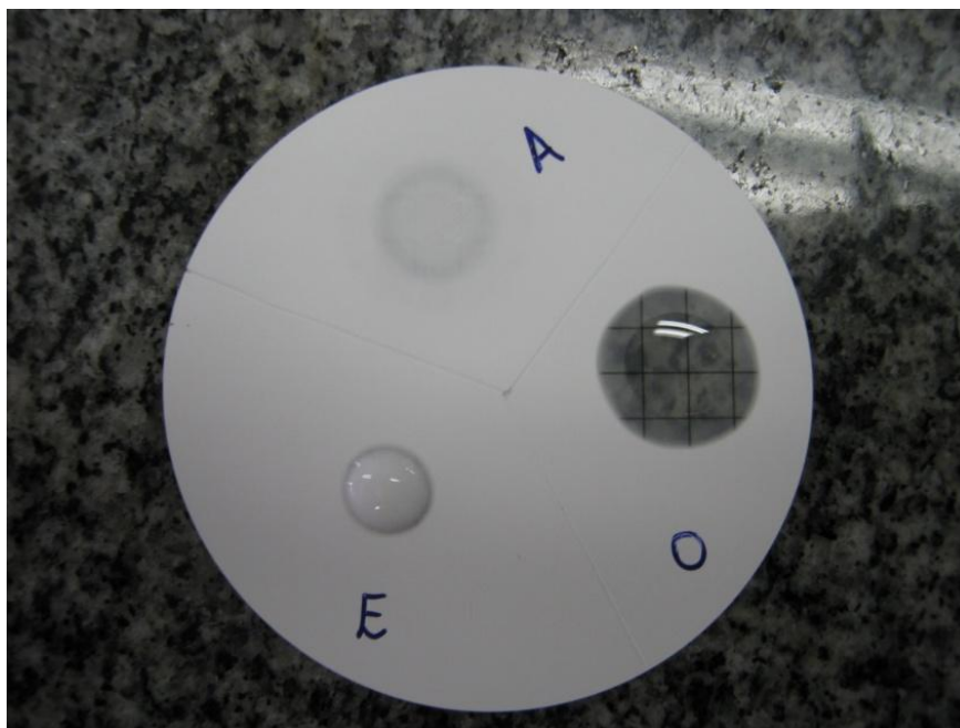
Figura 27: Teste de molhabilidade realizado na membrana de nitrato de celulose. Tem-se que: A = gota de água, O = gota de óleo mineral e E = gota de mulsão.
