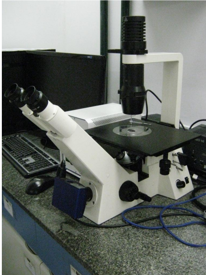
Figura 28: Axiovert 40 MAT Inverted Microscope, utilizado para observar o comportamento das emulsões.
