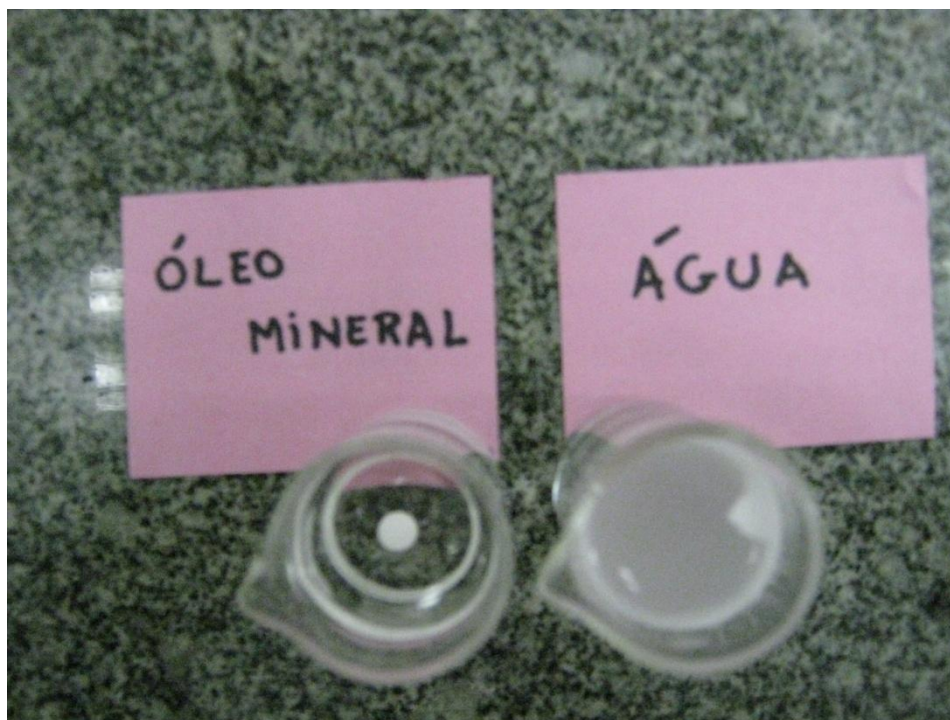
Figura 26: Teste de solubilidade. No béquer da esquerda temos uma gota de emulsão em óleo mineral. No da direita, temos uma gota de emulsão em água deionizada.
