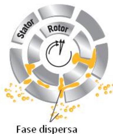
Figura 2: Seção transversal de um agitador do tipo rotor-estator.
