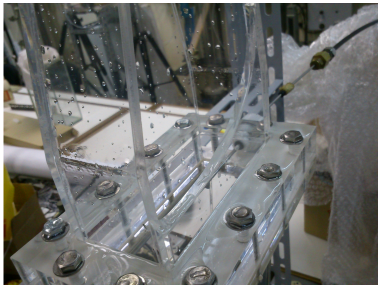
Figura 4.12: Célula quebrada após injeção de gás.
